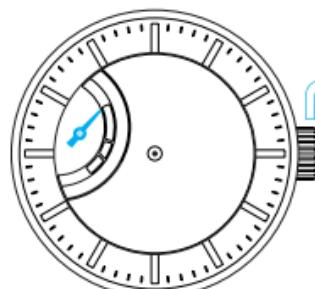
2. 滾動主發條直到電能儲存指示器顯示出滿弦狀態。此時，秒針開始移動。
