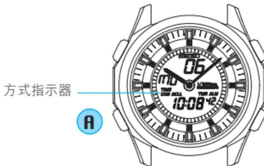
\*：無論在任何顯示方式下，若出現了不斷閃動的STOPWATCH/TIMER的指示，則說明秒錶/ 計時器正在計量。
